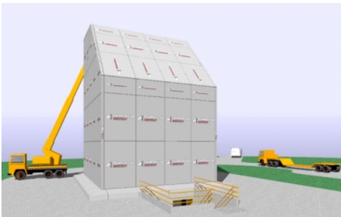
Figur 3.5. Testfaciliteten med adiabatisk paneler på alle flader (her også på taget).
