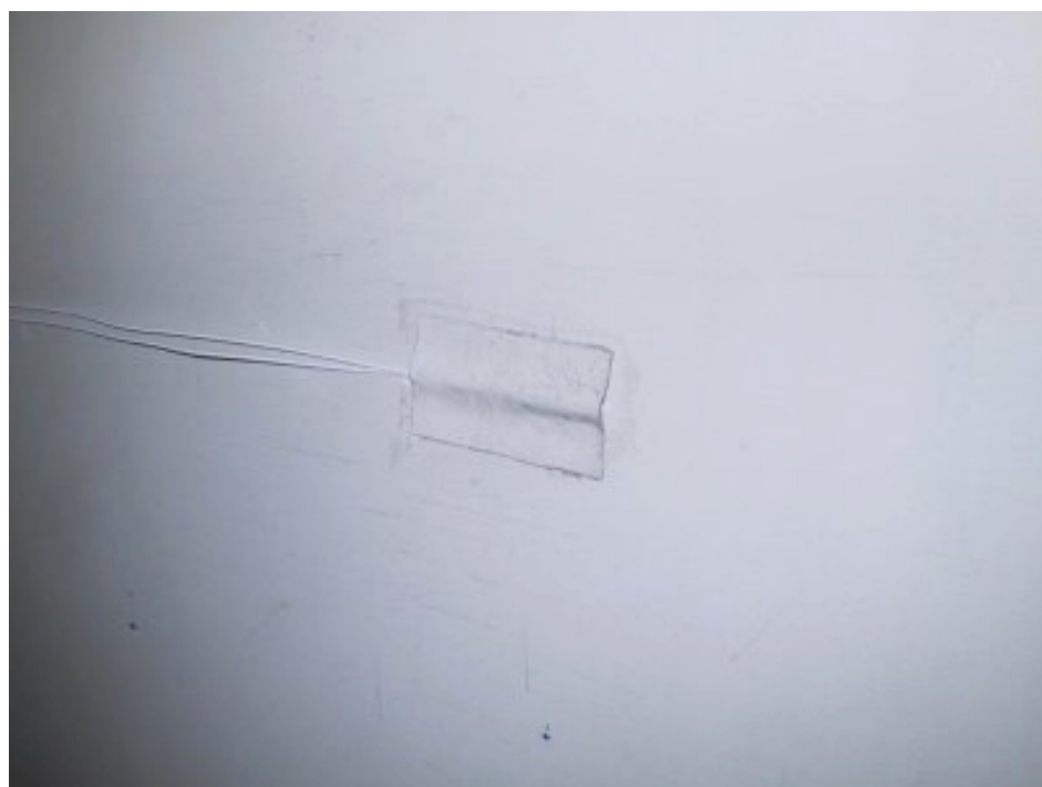
Figur 12. Lommen temperaturføleren på indersiden af testpanelerne var monteret i.
