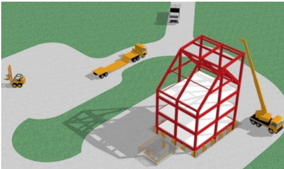
Figur 3.4. Testfacilitetens bærende skelet i maximum-konfigurationen med etageadskillelser.
