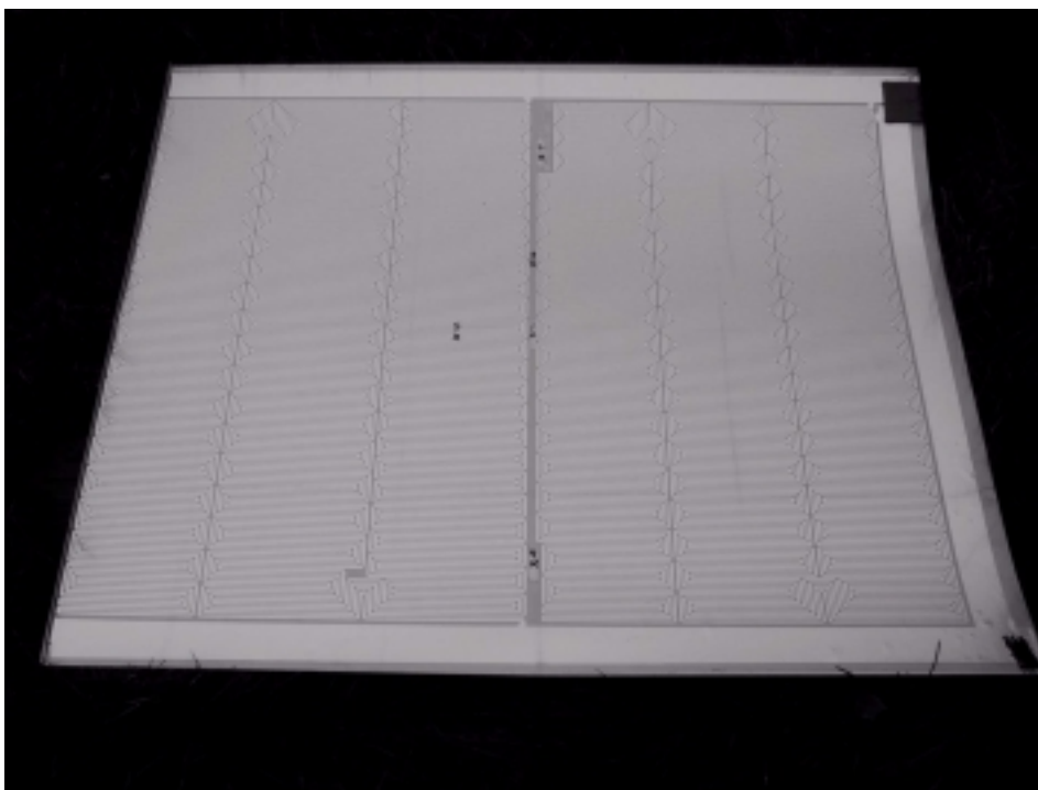
Figur 7 Varmefolie med markering af termofølernes placering
