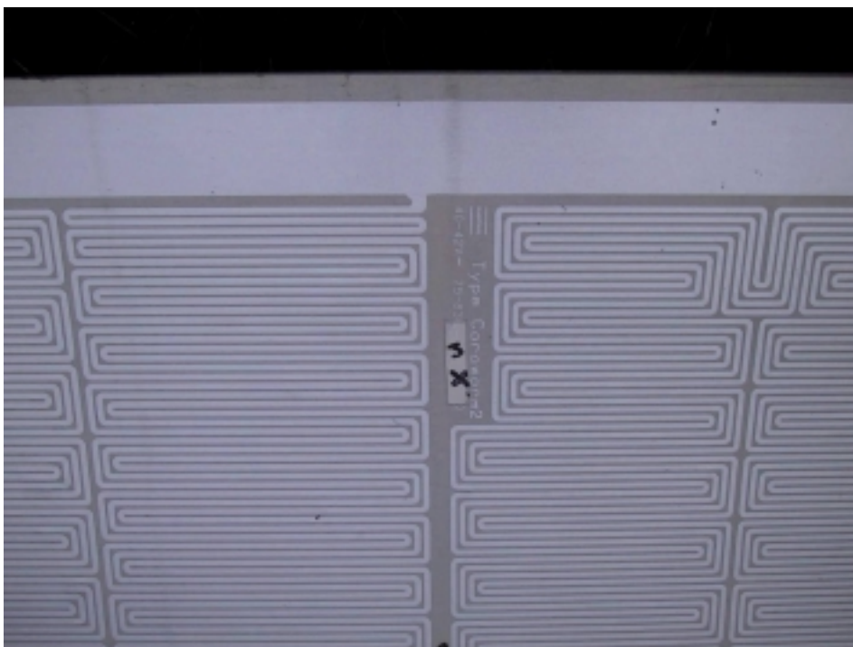
Figur 9 Varmefolie med markering af termofølernes placering - øverste del af folien
