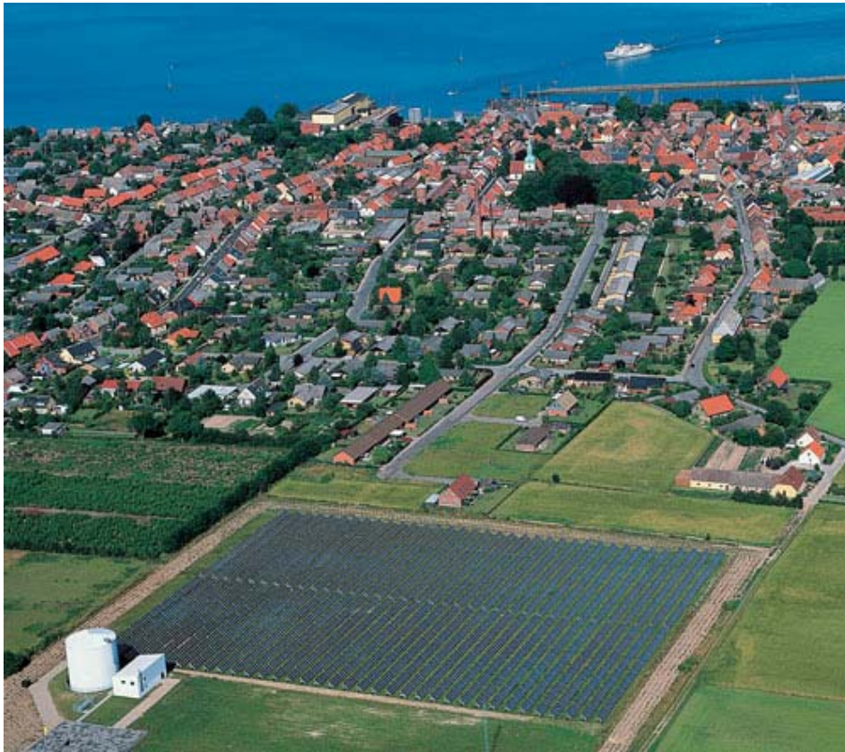
Figur 1.6. Solvarmeanlægget på 9.043 m 2 hos Marstal Fjernvarme. Akkumuleringsbeholderen på 2.100 m 3 ses i nederste venstre hjørne.
