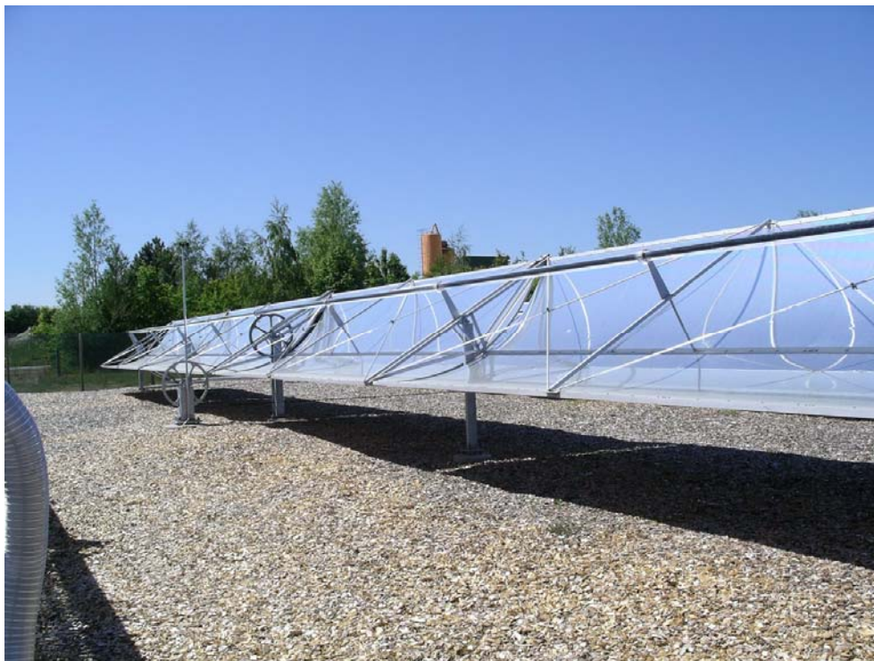
Figur 1.10. Fokuserende solfangere fra IST, USA.
