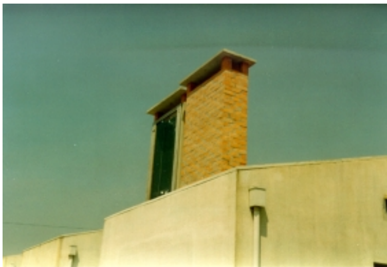
Figur 1.7. Forsøgsopstillingen på University of Porto til undersøgelse af effekten af en solskorsten.
