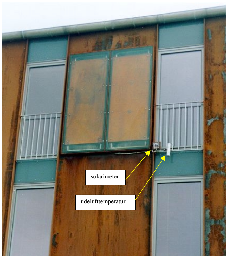
Figur 13. Placeringen af udelufttemperaturføler og solarimeter.
